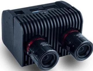
내장형 컴퓨팅 플랫폼과 스카이포트 연결을 갖춘 두 개의 초분광 이미징 카메라(VIS 에서 SWIR 대역)를 탑재한 UAV 용도의 다중 카메라 초분광 이미징 시스템. 비계약적 사진.
